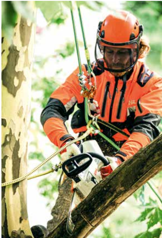
Akku-Sägen sind geräusch- und emissionsarm, hier die MSA 161 T mit Führungsschiene Light von Stihl
