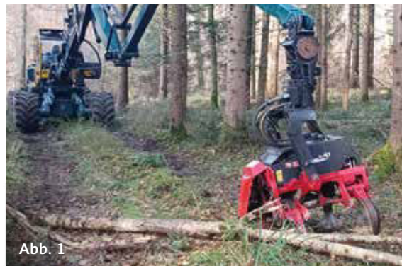
Abb. 1: Fäller-Vorrück-Fahrzeug des Projekts Outreach.
